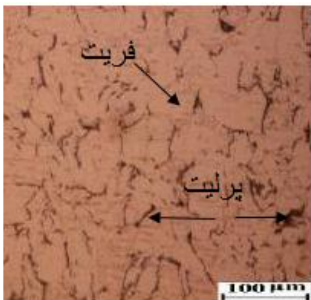
شکل ۲: ریز ساختار فولاد ASTM A106-Gr.B مورد استفاده.
