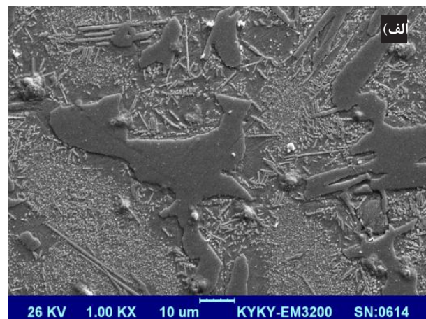
شکل ۴- تصاویر میکروسکوپ نوری پس از عملیات حرارتی با مقادیر مختلف آستنیت باقیمانده: الف) ۴۸٪ (نمونه ۱۶) ب) ۳۳٪ (نمونه ۹) و ج) ۲۶٪ (نمونه ۵).
