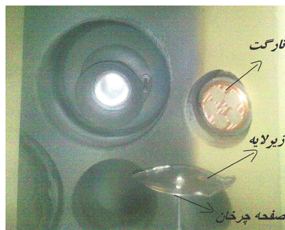
تصویر ۳. محل قرارگیری تارگت و زیرلایه در دستگاه رسوب فیزیکی بخار.
