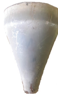
شکل ۲. نمایی از پوسته‌ی مخروطی تولید شده به روش الکتروفورمینگ
