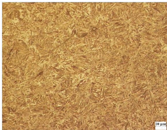
شکل ۴. ریزساختار نوری از فولاد پایه ۴۳۴۰ در شرایط عملیات حرارتی کوئنچ و بازپخت شده
