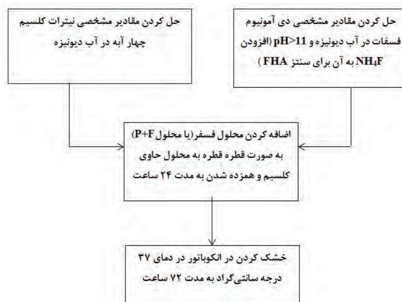
شکل ۲. نمودار سنتز پودر هیدروکسی آپاتیت و فلونور هیدروکسی آپاتیت بدون انجام کلسیناسیون و از طریق تنظیم pH محلول
