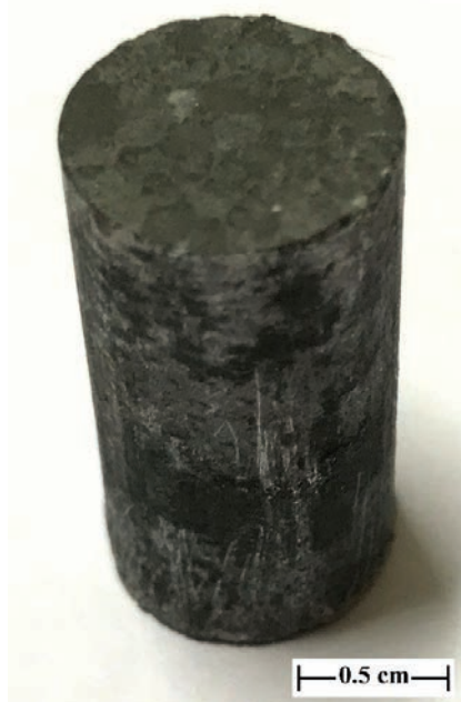
شکل ۳. تصویر نمونه فوم فولادی اولیه بعد از فرآیند فشردن.
