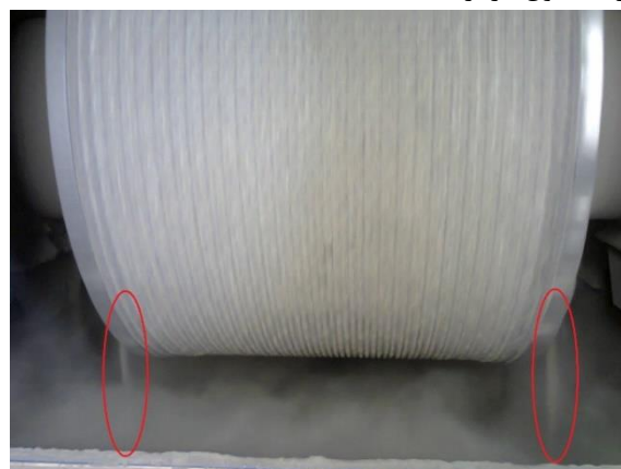
شکل ۴: میانبرزدن خوراک در لبه‌های غلتک‌های HPGR
