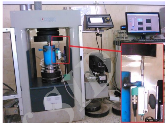
شکل ۱۱: پرس هیدرولیکی و ابزار اندازه‌گیری تغییر ارتفاع پیستون در آزمایشگاه مکانیک سنگ شرکت گل گهر
