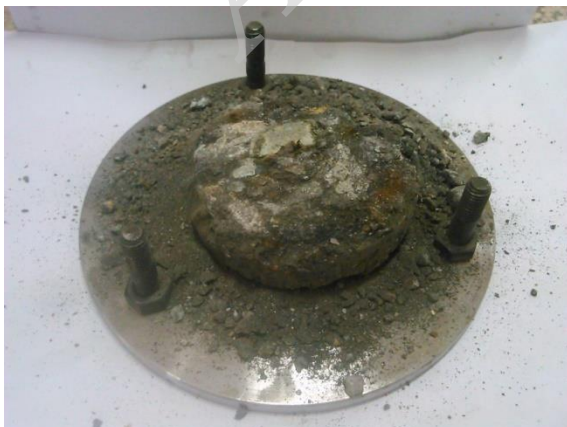
شکل ۱۰: کیک خروجی از سیلندر بعد از انجام آزمایش سیلندر و پیستون
