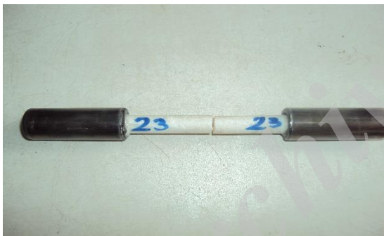
شکل ۵: نمونه شکسته شده از وسط
