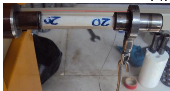
شکل ۴: چگونگی اعمال نیروی خمشی در نمونه‌ها
