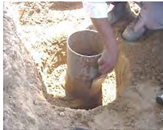
شکل ۲: تهیه نمونه دست نخورده توسط لوله استوانه‌ای شکل برای آزمایش سه محوری خاک
