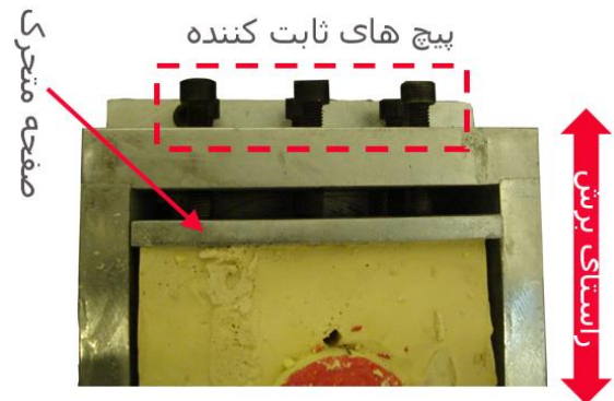
شکل ۶: طراحی جعبه برش همراه با یک صفحه متحرک عمود بر راستای برش و پیچ‌های ثابت‌کننده
