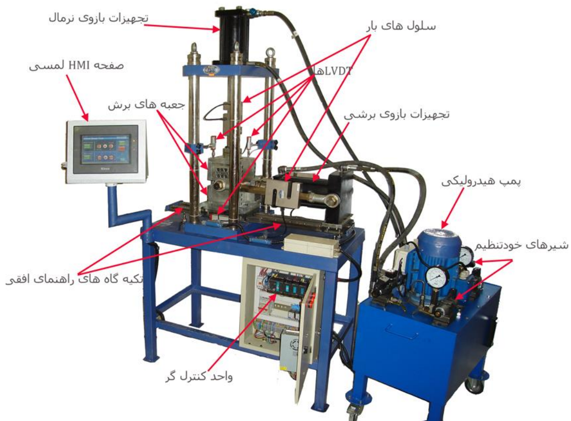
شکل ۱: تصویر دستگاه برش مستقیم خودتنظیم ساخته شده به همراه معرفی قسمت‌های مختلف آن
