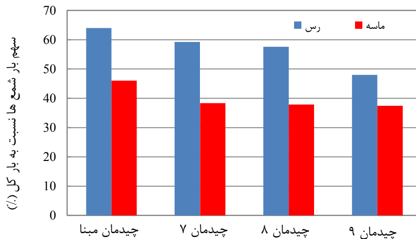
شکل ۲۰: سهم بارگیری شمع‌ها نسبت به بار کل
