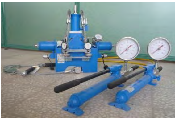
شکل ۵: دستگاه آزمایش برش مستقیم
