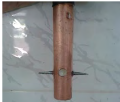
شکل ۲: سیستم مکانیکی ایجاد مشبک
