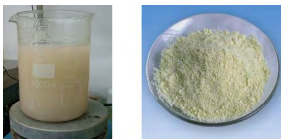
شکل ۶: نحوه آماده‌سازی سیال برای آزمایش شکست هیدرولیکی: (الف) پودر زانتان، (ب) سیال شکست
