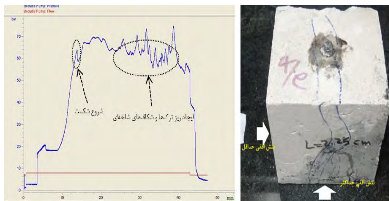
شکل ۱۲: بررسی تاثیر طول مشبک بر هندسه شکست: (الف) نمونه شکسته شده، (ب) نمودار فشار- زمان (آزمایش شماره ۵)
