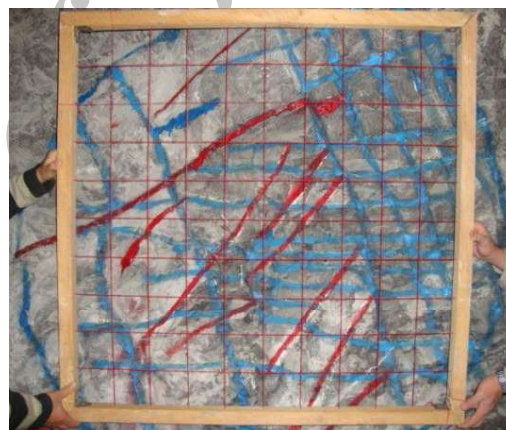
شکل (۱۰): پنجره نمونه‌برداری با شبکه‌بندی ۱۰*۱۰ سانتی‌متر در موقعیت SWL2
