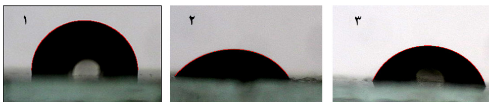
شکل ۶- زاویه تماس آب در هوا با سطح شیشه ۱- قبل از جذب ۲- پس از جذب محلول پلیمری پلی‌اکریل‌آمید سولفون‌ه، ۳- پس از جذب سامانه شبکه‌ای شده پلی‌اکریل‌آمید سولفون‌ه-کروم (۵۰/۵۰۰ ppm)
