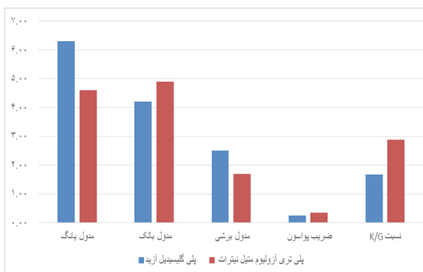
شکل ۶ - مقایسه خواص مکانیکی GAP و GTP در دمای ۲۹۸ کلوین
