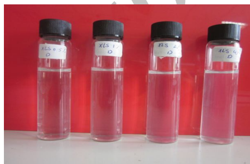
شکل ۳- پایداری سوسپانسیون‌های مختلف نانوذرات لاپونیت در آب مقطر پس از گذشت یک ماه (غلظت نانوذرات به ترتیب از چپ به راست ۰/۵، ۱، ۲ و ۴ درصد وزنی).
