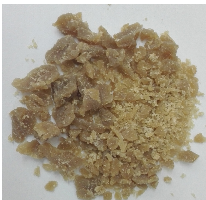
شکل ۲ نمونه ژل ذره‌ای از پیش تشکیل شده خشک شده
