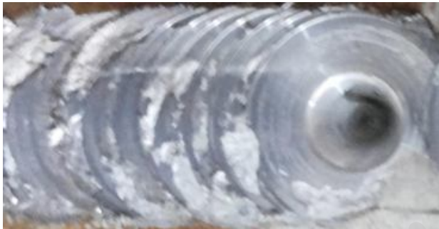
Fig. 12 Surface material flow in joint which welded by 1° tool tilt angle شکل 12 جریان سطحی اتصال در زاویه انحراف 1 درجه
