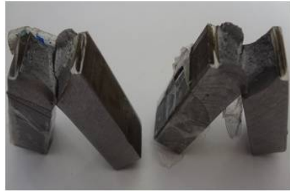
شکل 20 سطح مقطع شکست نمونه‌های آزمون ضربه
