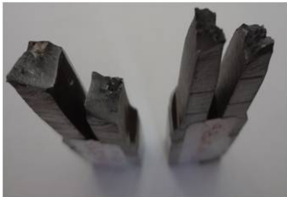
شکل 19 سطح مقطع شکست نمونه‌ها Fig. 19 The cross-sectional area of samples rupture
