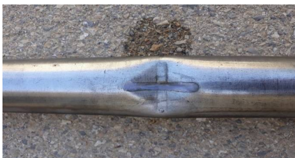
Fig. 7 An experimental repaired specimen after the indentation test شکل 7 یک نمونه آزمایشی تعمیرشده، بعد از انجام تست لهیدگی موضعی
