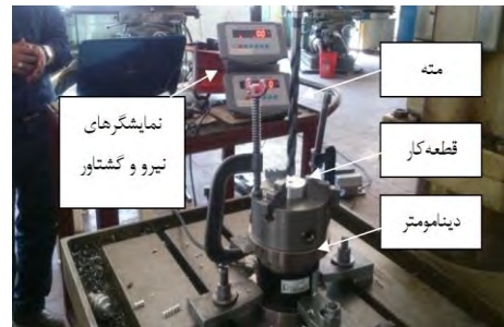
شکل ۲ بستر آزمایش برای اندازه‌گیری نیروی محوری و گشتاور برشی
