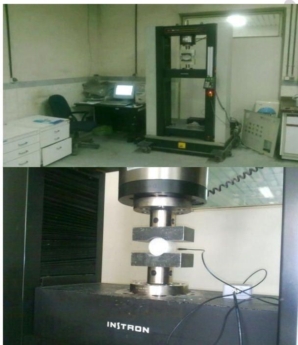
شکل ۳: دستگاه بارگذاری خودکنترل الکتریکی و سنسور ثبت امواج صوتی
