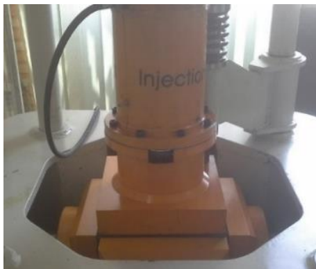
شکل ۱۰- جانمایی واحد تزریق بر روی نمونه و اعمال بار قائم
