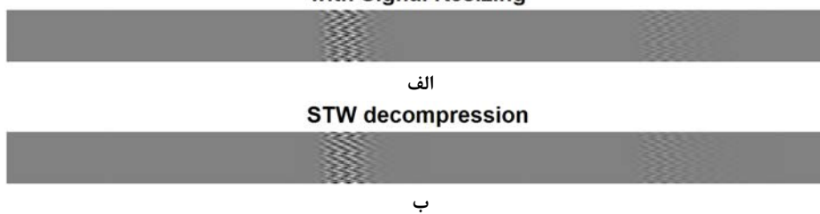
شکل ۵. (الف) یک نمونه تصویر PCG پس از انجام درونیابی، (ب) نتیجه فشرده‌سازی و بازسازی تصویر الف به کمک کدگذار/کدگشای STW
