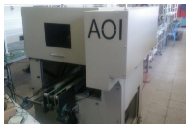
شکل ۲: شمای واقعی دستگاه نظارت نوری
