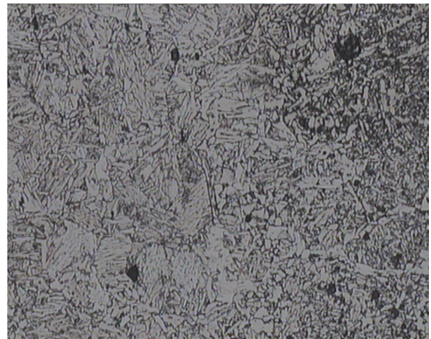
شکل 8 - ریزساختار میکروسکوپ نوری منطقه‌ی متاثر از حرارت واقع در لوله‌ی اصلی
