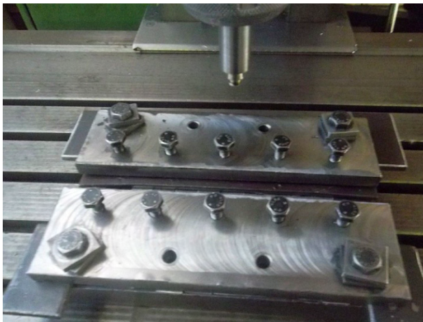
شکل 1- سیستم گیره بندی استفاده شده برای جوشکاری
