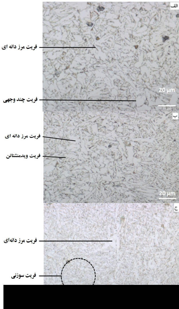
شکل ۴- ریزساختار فلز جوش نمونه G1
