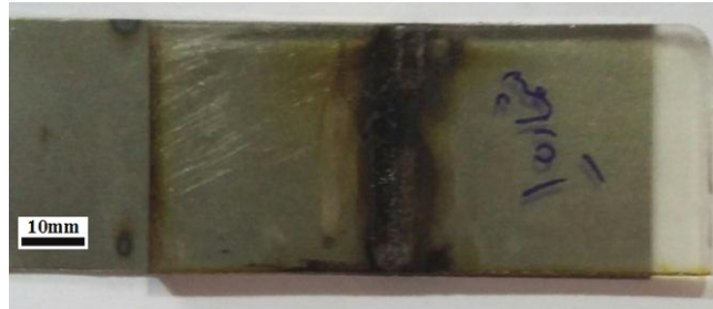
شکل ۶ - نمونه های جوشکاری St12 و پلی کربنات
