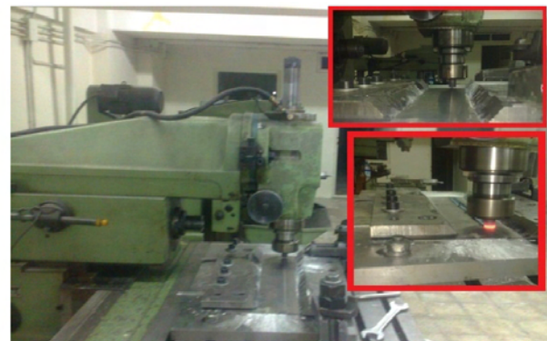
شکل 2- دستگاه فرز سه محوره و قید مورد استفاده در این تحقیق.
