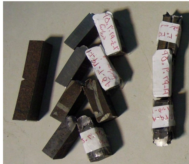
شکل ۱۹- سطح مقطع شکست نمونه های آزمون ضربه
