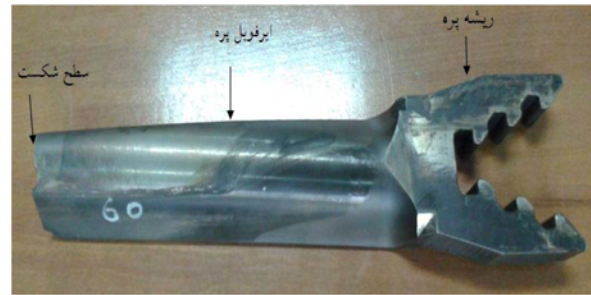
شکل ۱- پره شکسته شده
