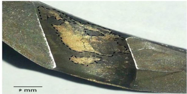
شکل ۶- عدم پیوستگی فلز لحیم باقی مانده درون سوراخ ایرفویل پره.
