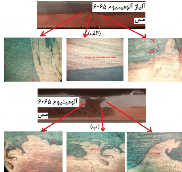
شکل ۵- جریان داخلی مواد اتصالی که با پین (الف) ساده و (ب) رزوه ای جوشکاری شدند
