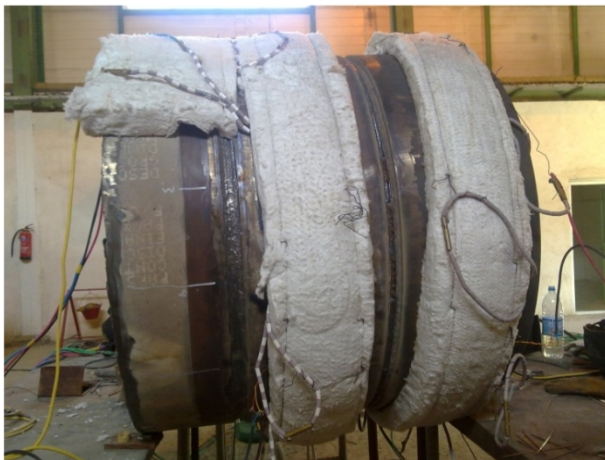
شکل ۳- نحوه ی عملیات پیشگرم با استفاده از نوارهای سرامیکی
