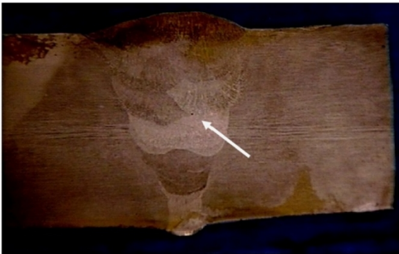
شکل ۱۵- تصویر ماکروسکوپی از مقطع آماده سازی شده ساعت ۱۲
