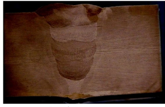
شکل ۱۴- تصویر ماکروسکوپی از مقطع آماده سازی شده ساعت ۹
