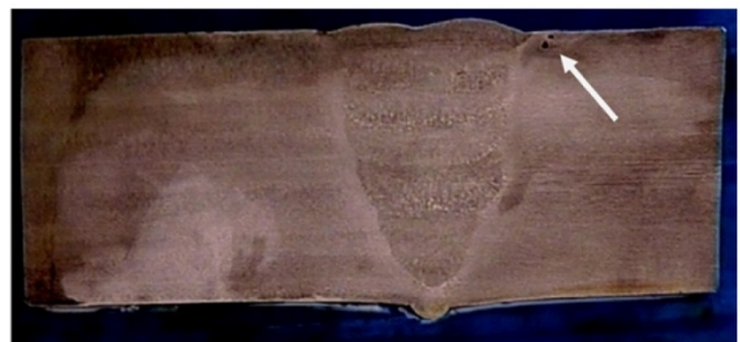
شکل ۱۰- تصویر ماکروسکوپی از مقطع آماده سازی شده نمونه Intersection
