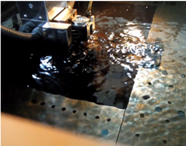
شکل 1- برشکاری با استفاده از دستگاه واترجت
