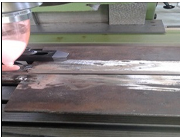
شکل 2- توزیع نانو مواد در طرح اتصال جوش
