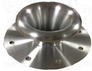
شکل ۳- نازل اندازه‌گیری دبی جرمی جریان کمپرسور
