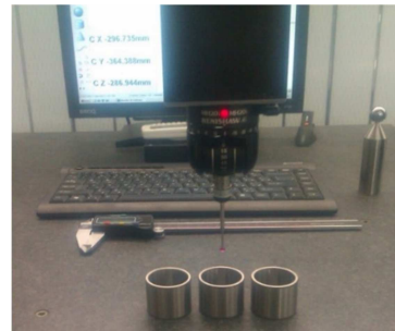
شکل ۳- اندازه‌گیری ابعاد بوش توسط ماشین اندازه‌گیری مختصات
