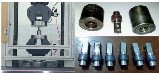
شکل ۱۴- محور و بوش سرهم بندی شده و فیکسچر مورد استفاده جهت اندازه گیری تجربی نیروی استخراج محور به همراه پرس یونیورسال
