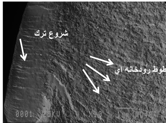
شکل ۱۰- ترک‌های شرع شده از سطح و خطوط رویدخانه‌ای
