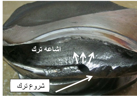
شکل ۳- سطح شکست ژورنال ثابت
