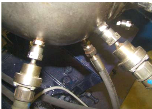
شکل ۵- نحوه‌ی نصب حس گرها روی سطح
