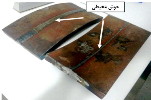
شکل ۲- تصویر صفحه‌های جوشکاری شده
