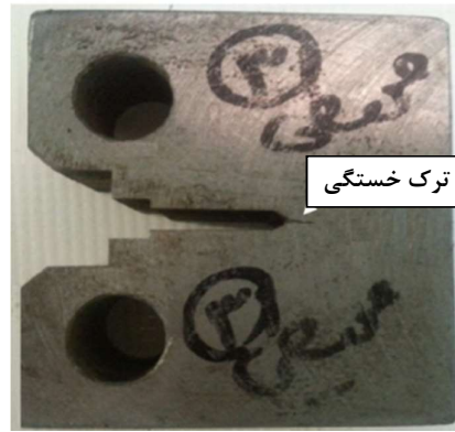
شکل ۸- تصویر یک نمونه CT با ترک خستگی
