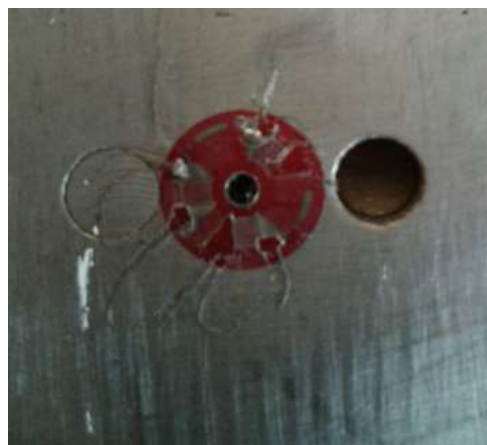
شکل ۱۰- اندازه گیری تنش پسماند به روش آزمایشگاهی
