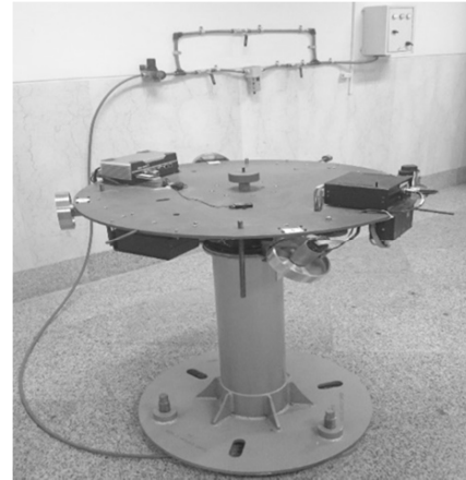
شکل ۱- شبیه‌ساز زیرسیستم کنترل وضعیت ماهواره
