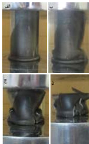
شکل ۱۳- آزمون لهیدگی لوله فلوفرمینگ شده با رزوه ریز
