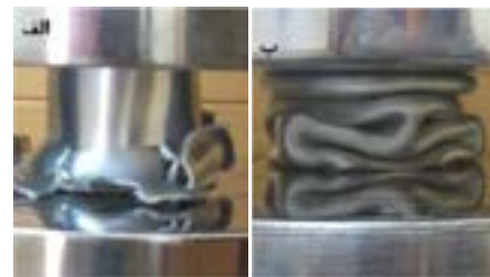
شکل ۱۰- لهیدگی نمونه‌های پرس شده در یکدیگر، الف- نمونه با آلومینیوم آنیل نشده، ب- نمونه با آلومینیوم آنیل شده
