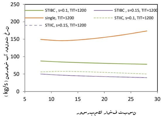
شکل ۱۱- اثر تغییرات نسبت فشار کمپرسور بر تولید آب شیرین در سه سیستم تولید همزمان چرخه توربین گاز با آب شیرین کن METVC و TIT=1100 °C
