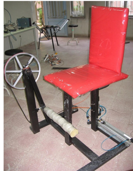
شکل ۱- نمونه آزمایشگاهی ساخته شده از دستگاه توانبخشی ایزوکینتیک
