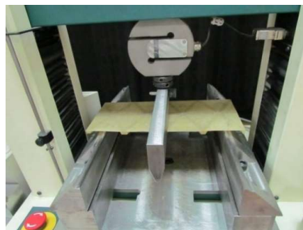
شکل ۵- نحوه قرارگیری نمونه مشبک کامپوزیتی تحت بارگذاری خمشی از سمت پوسته
