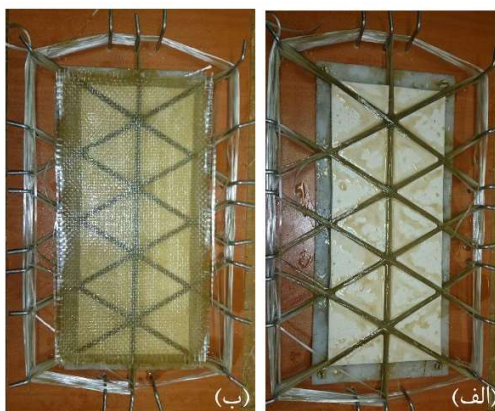
شکل ۳- مراحل اصلی برای ساخت نمونه‌های مشبک کامپوزیتی، (الف) لایه‌گذاری و ساخت ریب‌ها، (ب) لایه‌گذاری و ساخت پوسته
