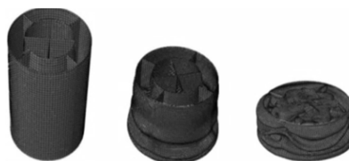
شکل ۹- لوله دوجداره با لوله داخلی مخروطی و سلول بندی شده
