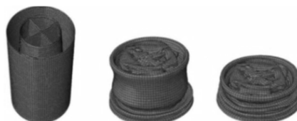
شکل ۷- لوله دوجداره با لوله داخلی مخروطی چندسلولی
