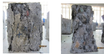
شکل ۸- شکست بتن تحت آزمون فشاری در سن ۲۸ روز، (الف) بتن نرمال (ب) بتن حاوی ذرات لاستیک
