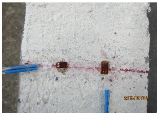
شکل ۱۴- کرنش سنج چسبیده بر سطح بتن حاوی ذرات لاستیک تایر ضایعاتی در فاصله ۱۰ سانتیمتری از تکیه‌گاه
