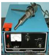
شکل ۷- دستگاه آزمون تراسونیک
