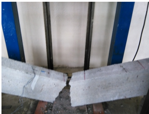
شکل ۱۳- شکست تیر بتنی حاوی ذرات لاستیک تحت آزمون ضربه با وزنه رها شونده
