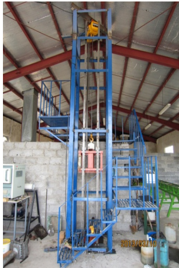
شکل ۱۰- دستگاه آزمون ضربه توسط ضربه رها شونده
